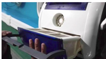
7. Skjut in filterfacket i poolroboten igen längs spåret
