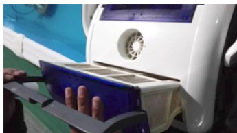
7. Työnnä suodatinkotelo takaisin allasrobottiin uraa pitkin
