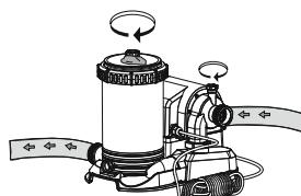
**IMPORTANTE: NÃO COLOQUE A BOMBA EM FUNCIONAMENTO SEM ÁGUA** – Certifique-se que as válvulas de entrada e de saída da piscina estão cobertas de água antes de colocar a bomba em funcionamento.
