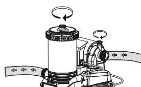
**TÄRKEÄÄ: ÄLÄ KUIVAKÄYTÄ PUMPPUA – Varmista ennen suodatinpumpun käyttöä, että sekä altaan tuloventtiili että lähtöventtiili on täysin veden peitossa.**
