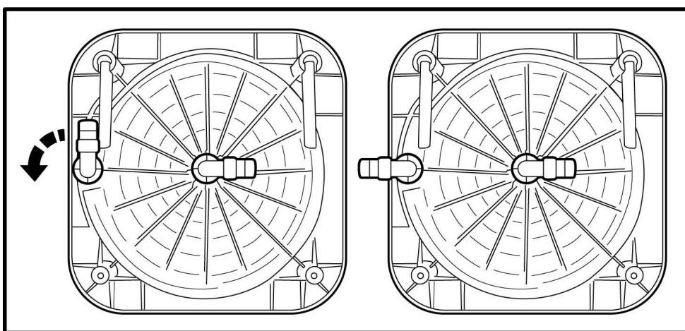
For at afmontere slangeforbindelserne fra hovedbunden, drej da tilslutningerne med uret, indtil de stopper, og træk dem derefter væk. For at samle slangeforbindelsen til hovedbasen skal du gøre det modsatte for at afslutte samlingen.
