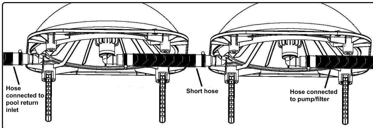
For tilslutning af 3 eller flere solvarmepaneler kræver det, at der er installeret en 3-vejs ventil (medfølger ikke) og "T" stik (medfølger ikke). Nedenfor er et eksempel på overjordisk pool med 3-vejs ventil opsat på plads.
